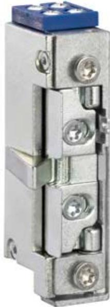
Der Vektortüröffner A4020-F überzeugt durch seine kleinen Maße und das fast lautlose Öffnungsverhalten bei Gleichstrom auch unter hoher Vorlast. Durch einen 2 mm längeren Entriegelungshebel kann der Türöffner mechanisch dauerentriegelt werden.
