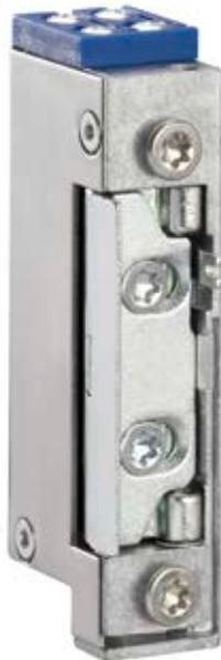
Der Vektortüröffner A4020 überzeugt durch seine kleinen Maße und das fast lautlose Öffnungsverhalten bei Gleichstrom auch unter hoher Vorlast. Durch einen 2 mm längeren Entriegelungshebel kann der Türöffner mechanisch dauerentriegelt werden.
