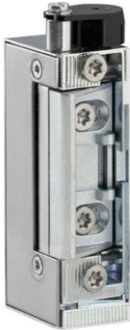
Der SILENCE-Feuerschutztüröffner FT200S dämpft den Rückschlag der Türöffnerfalle und gewährleistet dadurch, dass diese behutsam in ihre Ausgangssituation zurückfährt. Er ist für die Anwendung an Feuerschutztüren, bei denen aufgrund örtlicher Gegebenheiten kein Rückschlaggeräusch vorhanden sein soll, optimal geeignet.
