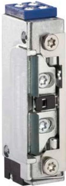
Der Vektortüröffner A4011-K überzeugt durch seine kleinen Maße und das fast lautlose Öffnungsverhalten bei Gleichstrom auch unter hoher Vorlast. Zusätzlich besitzt er einen Schaltkontakt (Rückmeldung), welcher von der Schlossfalle betätigt wird. Durch einen Entriegelungshebel kann der Türöffner mechanisch dauerentriegelt werden.
