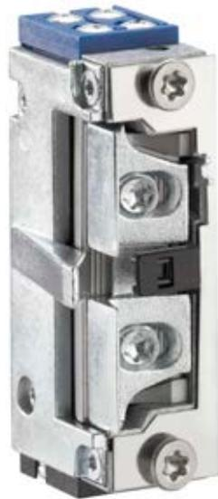
Der Kompakttüröffner A5021-F überzeugt durch seine kleinen Maße. Zusätzlich besitzt er einen Schaltkontakt (Rückmeldung), welcher von der Schlossfalle betätigt wird. Durch einen 2 mm längeren Entriegelungshebel kann der Türöffner bequem mechanisch dauerentriegelt werden.
