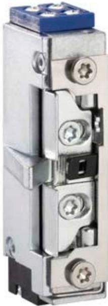
Der Vektortüröffner A4011-F überzeugt durch seine kleinen Maße und das fast lautlose Öffnungsverhalten bei Gleichstrom auch unter hoher Vorlast. Zusätzlich besitzt er einen Schaltkontakt (Rückmeldung), welcher von der Schlossfalle betätigt wird. Durch einen Entriegelungshebel kann der Türöffner mechanisch dauerentriegelt werden.
