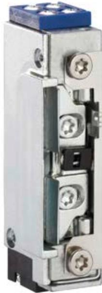
Der Vektortüröffner A4021-K überzeugt durch seine kleinen Maße und das fast lautlose Öffnungsverhalten bei Gleichstrom auch unter hoher Vorlast. Zusätzlich besitzt er einen Schaltkontakt (Rückmeldung), welcher von der Schlossfalle betätigt wird. Durch einen 2 mm längeren Entriegelungshebel kann der Türöffner mechanisch dauerentriegelt werden.
