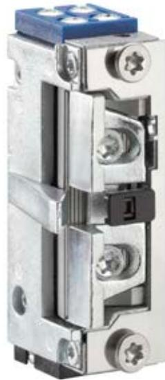
Der Kompakttüröffner A5013-F überzeugt durch seine kleinen Maße. Zusätzlich besitzt er einen Schaltkontakt (Rückmeldung), welcher von der Schlossfalle betätigt wird. Durch einen Entriegelungshebel kann der Türöffner mechanisch dauerentriegelt werden.
