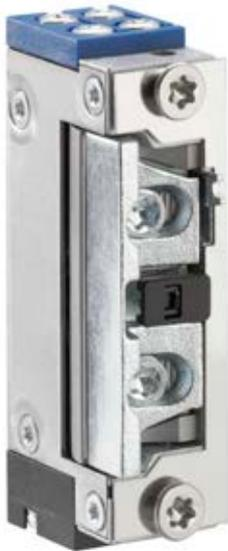
Der Kompakttüröffner A5023 überzeugt durch seine kleinen Maße. Zusätzlich besitzt er einen Schaltkontakt (Rückmeldung), welcher von der Schlossfalle betätigt wird. Durch einen 2 mm längeren Entriegelungshebel kann der Türöffner bequem mechanisch dauerentriegelt werden.
