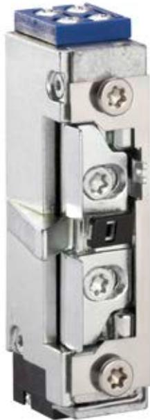
Der Vektortüröffner A4021-F überzeugt durch seine kleinen Maße und das fast lautlose Öffnungsverhalten bei Gleichstrom auch unter hoher Vorlast. Zusätzlich besitzt er einen Schaltkontakt (Rückmeldung), welcher von der Schlossfalle betätigt wird. Durch einen 2 mm längeren Entriegelungshebel kann der Türöffner mechanisch dauerentriegelt werden.
