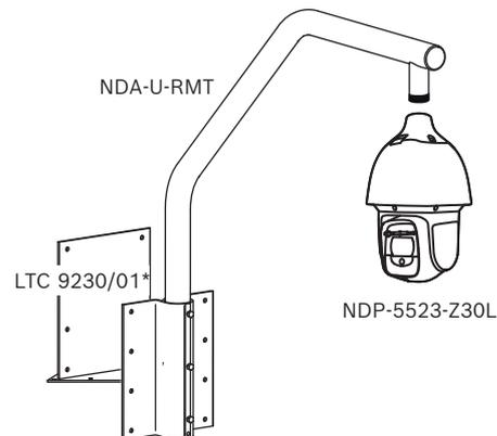
Abb. 3: Dachmontage (IP66)
