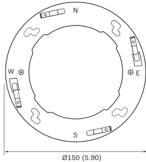
**Abmessungen der Aufputz-Montage**
