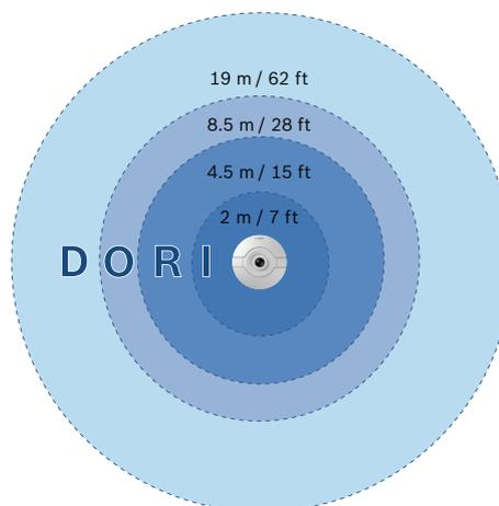
Bei einer Befestigung in 3 m Höhe hat die 180° Version der Kamera nachfolgenden Abdeckungsradius für die vier Stufen:
